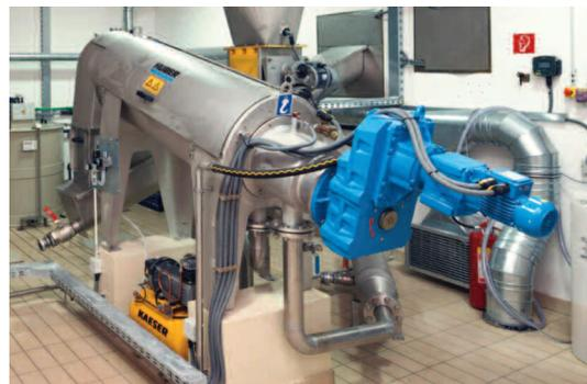
HUBER Schneckenpresse zur Entwässerung von Prozessschlamm
